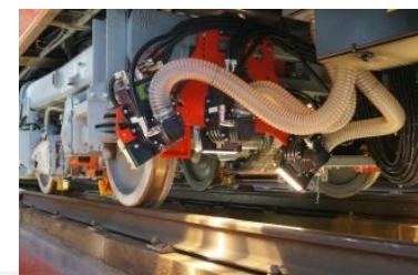
ВИДЕОКОНТРОЛЬ СОСТОЯНИЯ РЕЛЬСОВ И РЕЛЬСОВЫХ СКРЕПЛЕНИЙ
