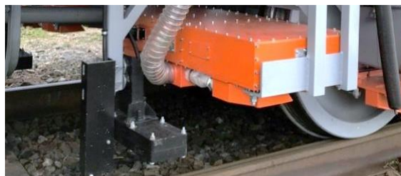
КОНТРОЛЬ СОСТОЯНИЯ ГЕОМЕТРИИ РЕЛЬСОВОЙ КОЛЕИ И РЕЛЬСОВ
